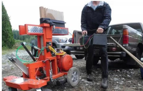
图 6 TreeRover 自动植树机器人
